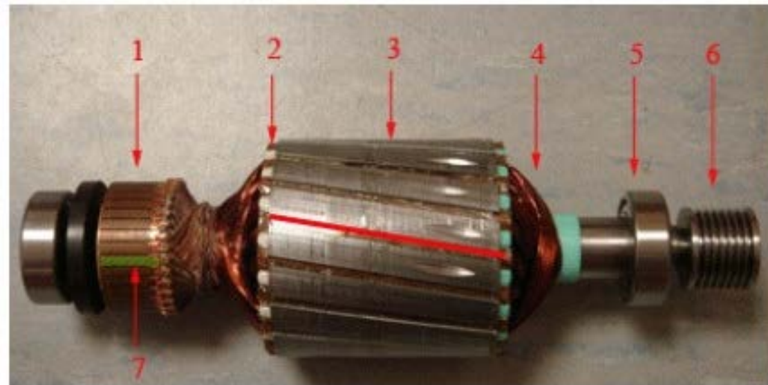
Abbildung 2: Anker 1 - Kommutator, 2 - Isolierstern, 3 - Ankerkern, 4 - Wicklung, 5 - Kugellager, 6 - Welle, 7 - Lamellen
